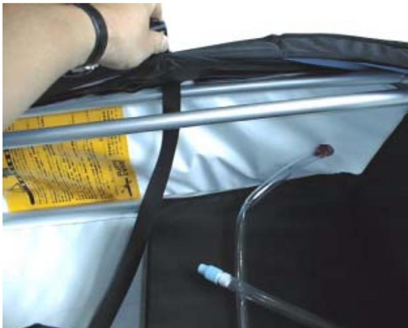
船体布後側に付いているベルトをキール部先端ガイド溝に沿わせ、さらにロープを両側に輪を作りデッキバー下側に回しフックに掛け、ロープを引いてテンションをかけます。(リヤードッキのファスナーが閉まる所まで)
